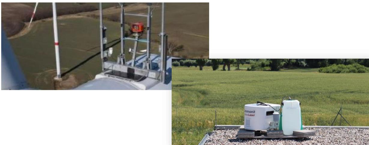
Abbildung 1: Lidar auf Gondel (links) und auf Dach eines Gebäudes (rechts)
