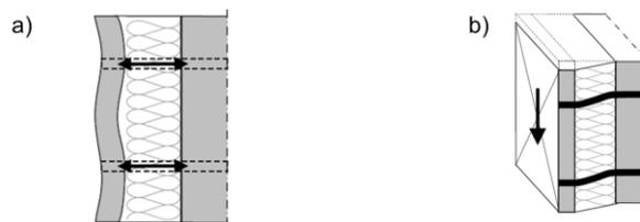
**Abbildung 4: a) Plattentragwirkung und b) Scheibentragwirkung**
