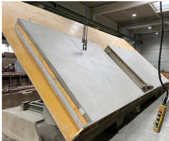
**Abbildung 8: Herstellung von Sandwichfassaden-Elementen im Fertigteilwerk Otto Knecht**
