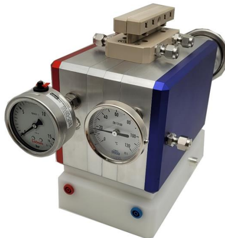
Abbildung 1: (links) Ein Fotografie des AEMWE-Laborprüfstands an der Westfälische Hochschule und (rechts) Fotografie eines AEMWE-Testsystems auf Basis der hydraulischen Verpressung von Einzelzellen
