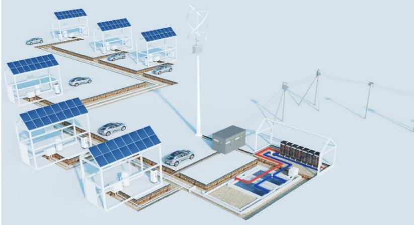
**Abbildung 3:** Kalte Nahwärme mit einem Batteriespeicherkraftwerk
