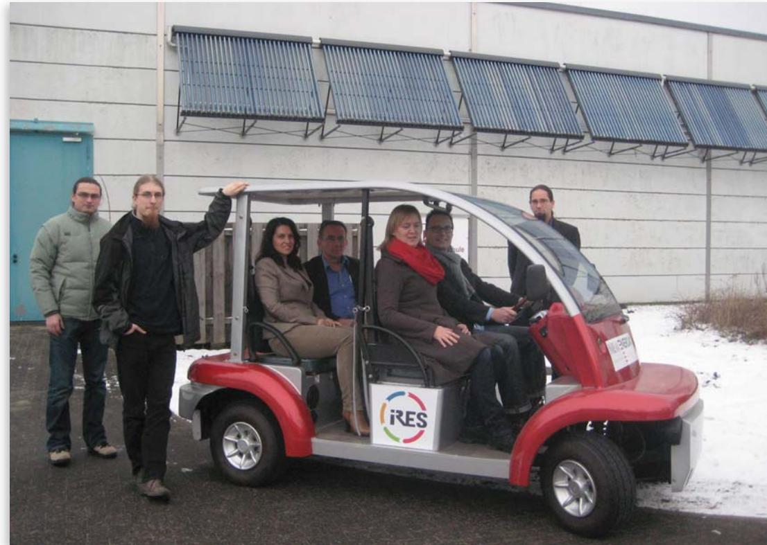
Abbildung: Das einsatzbereite GolfCaddy, angetrieben von einer SOFC.
