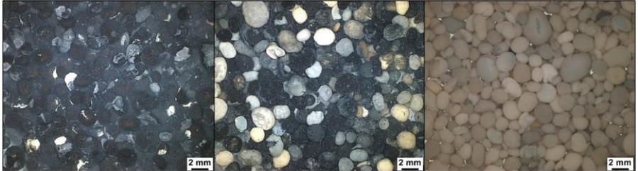
**Abbildung 2:** Stereomikroskopische Dokumentation mit Zeiss AxioZoom.V16 des Pelletschlammes (v.l.n.r.): vor Versuchsstart; nach Versuchsstart und am Versuchsende
