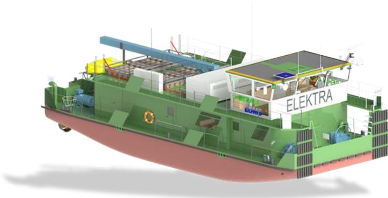
**Abbildung 1:** 3D-Darstellung des Kanalschubbootes ELEKTRA
