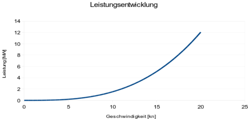
Abbildung 4: Benötigte Antriebsleistung in Abhängigkeit zur Schiffsgeschwindigkeit
