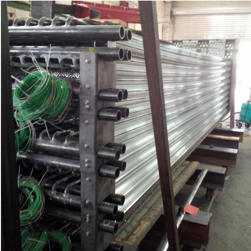
Abbildung 5: Bau des Latentwärmespeichers
