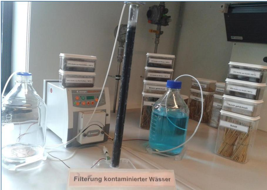
Abbildung 4: Biokohle als Filtermaterial in einer Säule zur Reinigung gefärbten Wassers<sup>13</sup>
