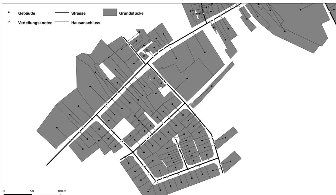
**Bild 2-3: Geoinformatiosgestützte Trassierung einer Nahwärmeleitung**
