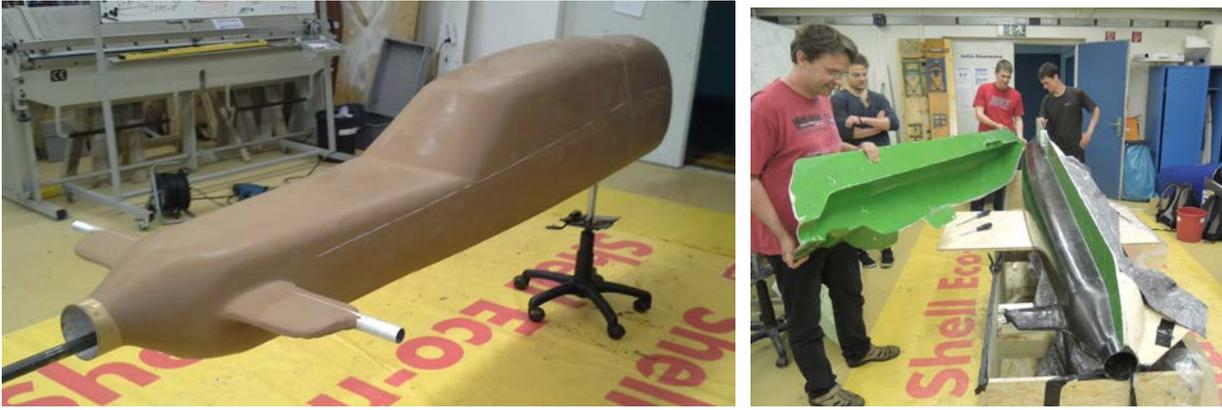
**Abbildung 2:** Links: Das Urmodell aus Industrieplastilin. Rechts: Negativform und Unterseite des laminierten Monocoque-Rahmens
