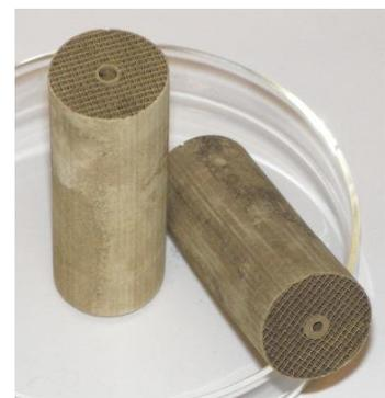
Abb. 4: Katalysatorbeschichtete keramische Monolithe für die SOFC-Brennstoffzelle.
