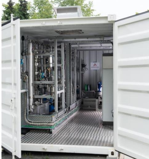
Abbildung 2: Aufbau der Demonstrationsanlage in einem 20 ft Container; ©AREVA GmbH
