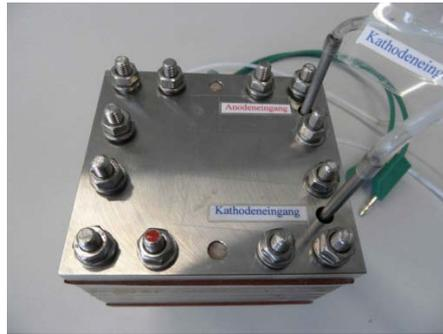
Abbildung 3: Stack aus drei Zellen
