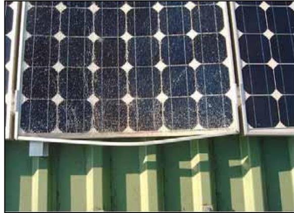
Bilder 3 und 4: Schneelasteinflüsse – unterdimensioniertes Montagesystem und Modulbeschädigungen
