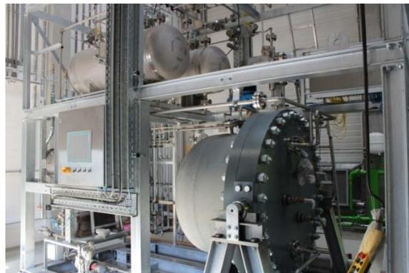
**Abbildung 1:** Foto des alkalischen Druckelektrolyseurs
