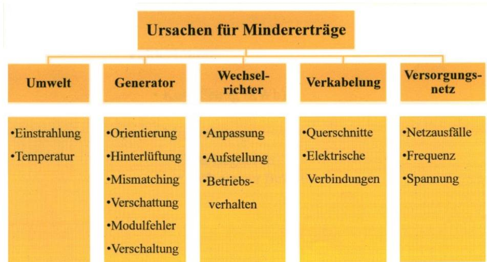
Bild 2: Einteilung der Fehlerarten von PV-Anlagen
