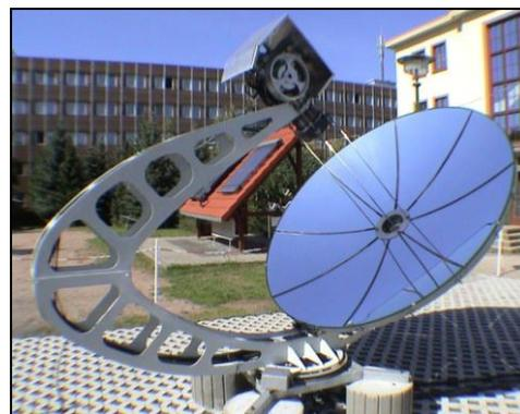
Bild 4: Solar-Stirling-Anlage auf dem Freigelände
