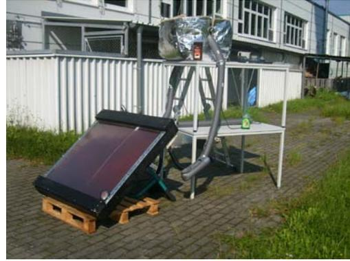
Bild 3: 700-W-Versuchskollektor (PMMA)
