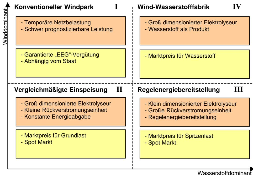
Abbildung 2: Technische und ökonomische Übersicht der Wind-Wasserstoff-Szenarien
