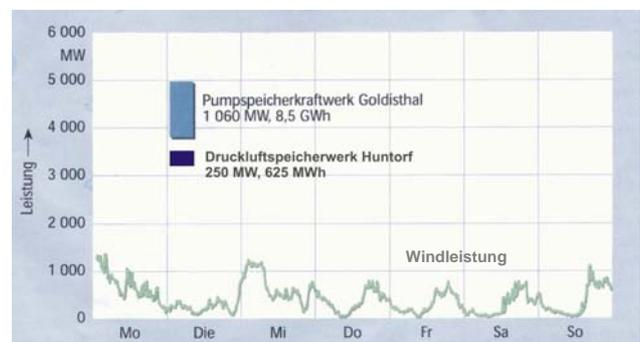
Bild 3 Netzlust und Leistung aus WEA im deutschen Verbundnetz vom 15.–21.03.2004 [7]
