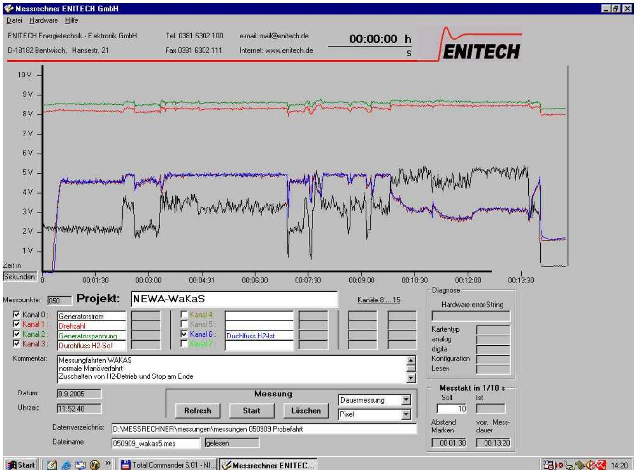
Bild 19: Generatorspannung, Generatorstrom, Drehzahl und Wasserstoffvolumenstrom-Soll und Ist bei Schiffsmanöverfahrt
