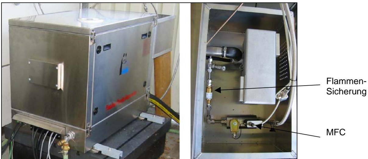
Bild 4: auf Dual-Fuel-Betrieb umgerüstetes AGT 30.000
