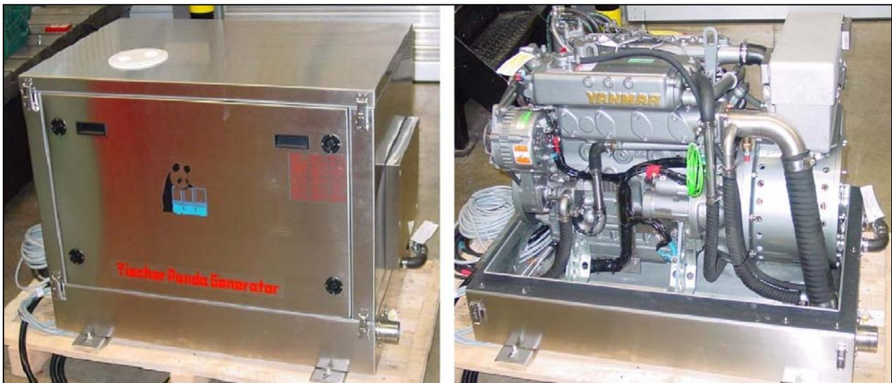
Bild 2: Panda AGT 30.000 mit Verbrennungsmotor Yanmar 4JH3E
