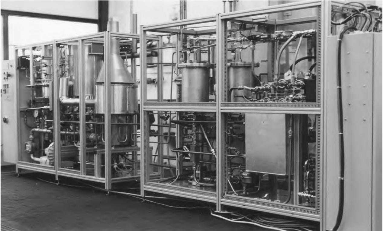
Abb. 1: 5 kW<sub>el</sub> PEMFC mit ISE – Erdgasreformer
