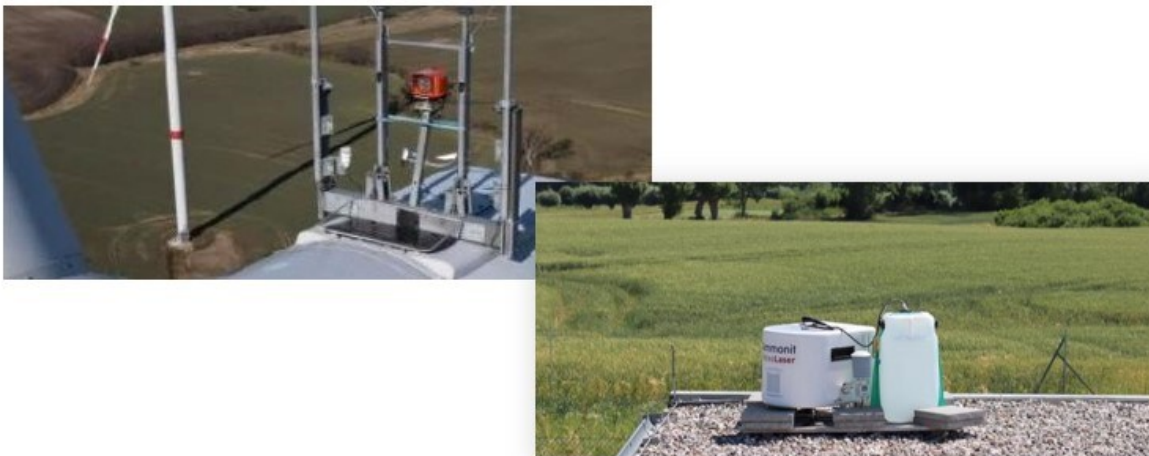
Abbildung 1: Lidar auf Gondel (links) und auf Dach eines Gebäudes (rechts)
