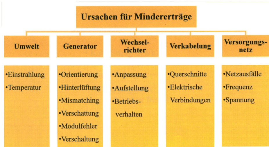
Bild 2: Einteilung der Fehlerarten von PV-Anlagen
