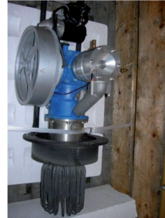
Stirlingmotor 3 kW thermisch, 1 kW elektr. Quelle: LFS Tulln
