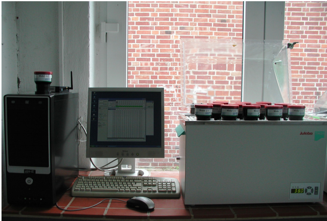
Abbildung 2: Ansicht des Gesamtsystems mit 12 Modulen: Wasserbad, PC zur Datenaufzeichnung und Nullmodul zur Erfassung des aktuellen Luftdrucks
