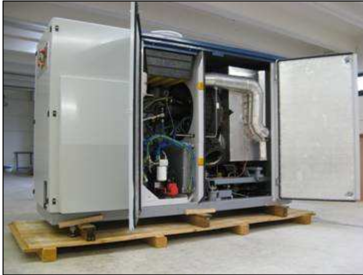
Abb. 3.: Mikrogasturbine Turbec T 100
