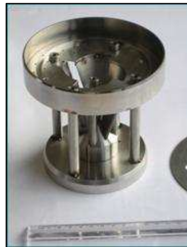
Abb. 4.: Vormischbrenner für H_2 reiche Gase mit Alstom-Technologie
