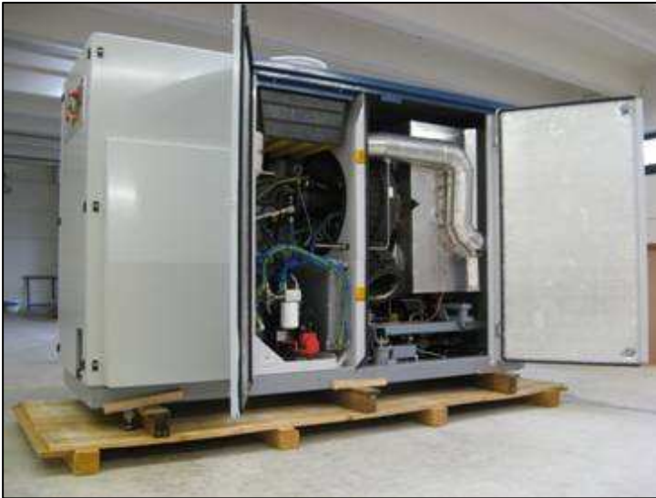
Abb. 3.: Mikrogasturbine Turbec T 100
