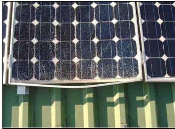
Bilder 3 und 4: Schneelasteinflüsse – unterdimensioniertes Montagesystem und Modulbeschädigungen
