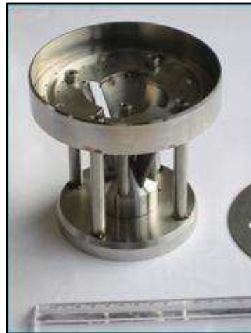
Abb. 4.: Vormischbrenner für H_2 reiche Gase mit Alstom-Technologie
