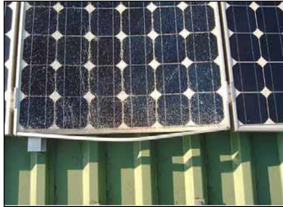
Bilder 3 und 4: Schneelasteinflüsse – unterdimensioniertes Montagesystem und Modulbeschädigungen
