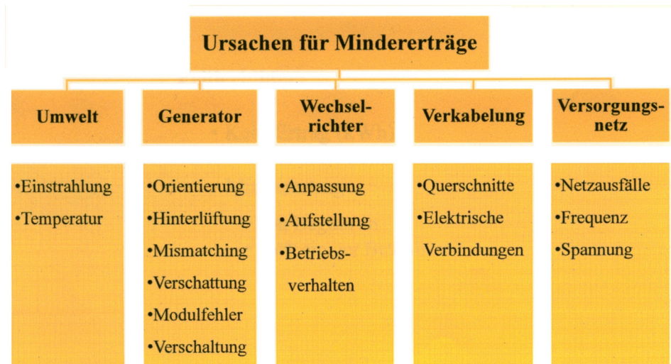
Bild 2: Einteilung der Fehlerarten von PV-Anlagen
