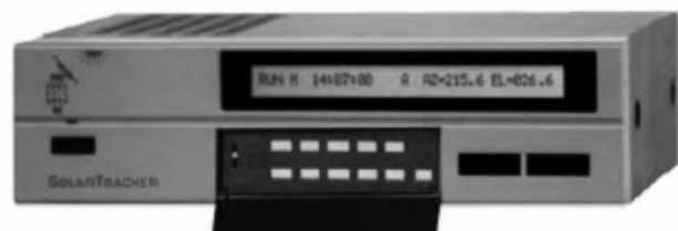
Bilder 2 und 3: Detailansicht der rechnergestützten Nachführungseinrichtung sowie entsprechende Steuereinheit
