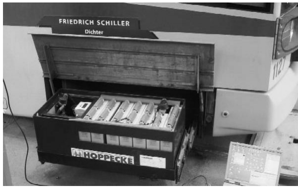
Fig 2: Beispiel einer FNH-Batterie (NiMH) für Straßenbahn
